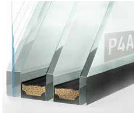
Dreifach Isolierscheibe inkl. einem VSG-Verbund-Sicherheitsglas mit 4-fach folierter PVB-Zwischenschicht, Qualitätsstufe P4A.
